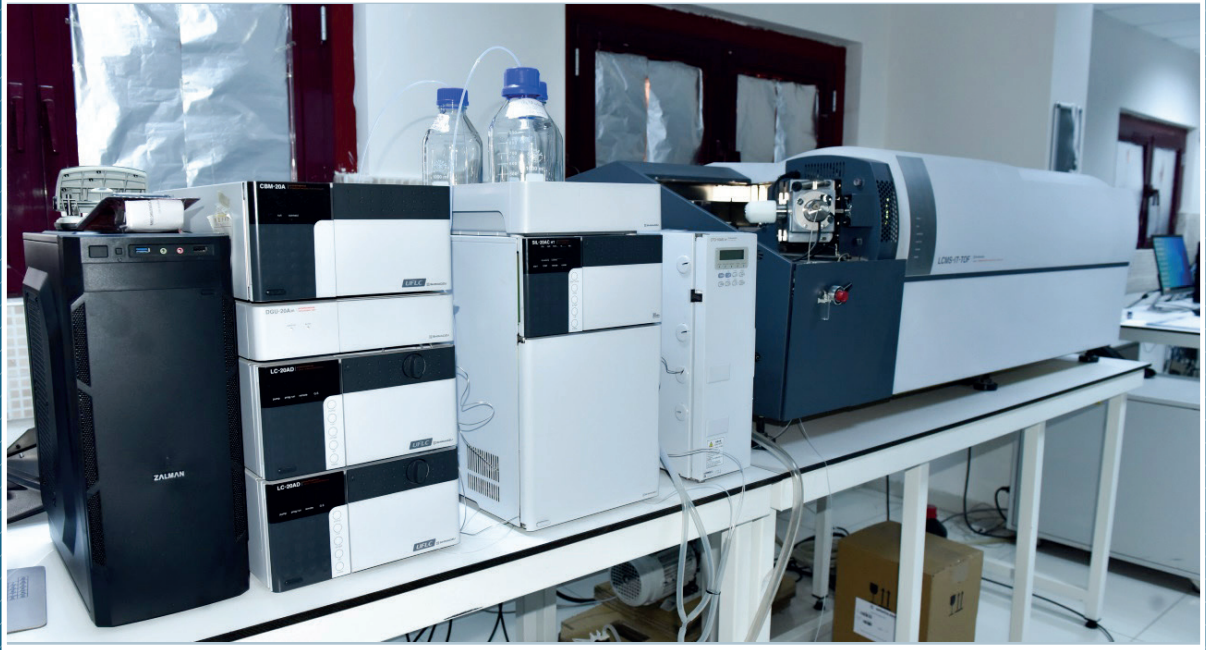
LC-MS IT-TOF Kütle Spektrometresi
