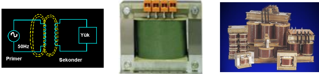
Şekil 17-1.1: Transformatör sembol ve görünüşleri
