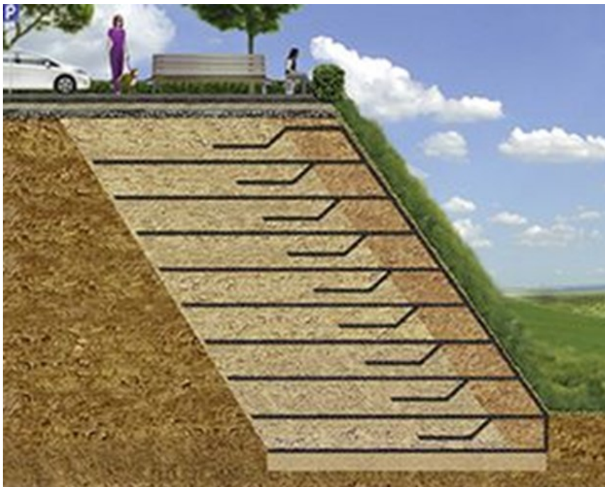
Şekil 1. Geosentetik donatılı istinat duvarı şematik gösterimi
